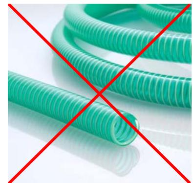
Dans le périmètre d'aspiration, on ne pourra pas utiliser de tuyaux flexibles, vu que le tuyau intérieur est mou et qu'il se rétracte en cas de sous-pression.
